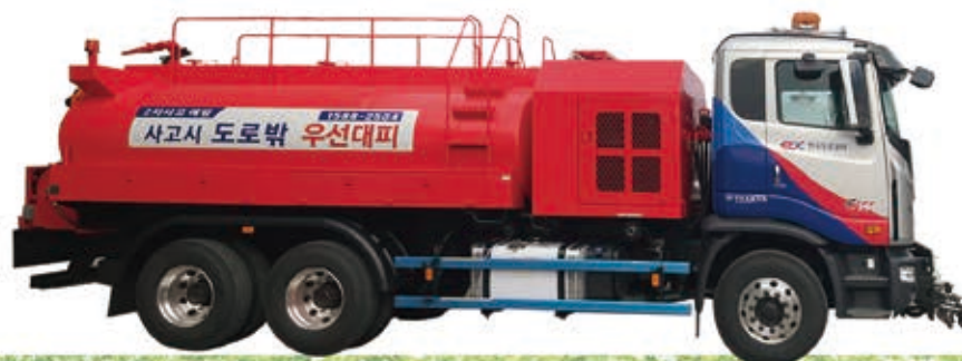
자동호스릴, 원터치 맨홀 장착 살수차 Full Auto Hose Reel & One touch manhole Water Sprayer Truck
