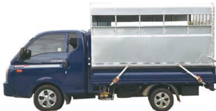
1톤 탈부착식 한우수송차 Detachable type Cow Carrier
